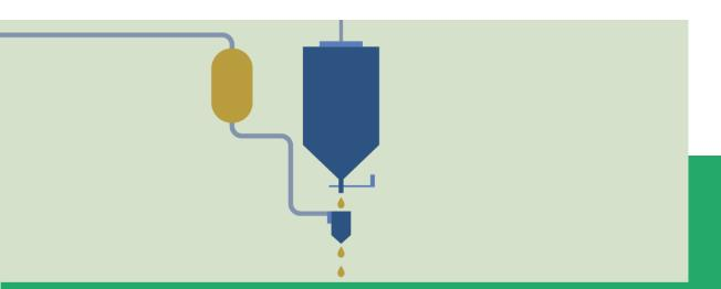
**Refinado:** Proceso al que se somete el Aceite de Orujo de Oliva crudo para hacerlo apto para el consumo. Se aplican dos tipologías diferentes: refinación física o refinación química. Consta de las siguientes operaciones: desgomado, neutralización, decoloración, winterización, descerado, desodorización y filtrado.
