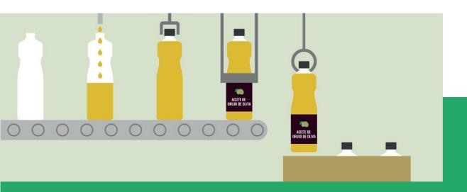
Envasado: El Aceite de Orujo de Oliva puede comercializarse tanto a granel como envasado. En este último caso, el proceso de envasado comprende los siguientes pasos: fabricación del envase o soplado, manejo y transporte del envase, llenado, sellado, etiquetado y embalaje.
